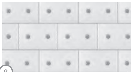
8 STYROPIAN – KOŁKI UMIESZCZA SIĘ CENTRALNIE NA POWIERZCHNI PŁYTY
