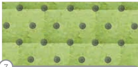
7 WEŁNA MINERALNA – KOŁKI UMIESZCZA SIĘ CENTRALNIE ORAZ NA ŁĄCZENIU NAROŻNIKÓW SĄSIADUJĄCYCH PŁYT
