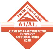
Über die Klasse des Klebers sagt die Bezeichnung für das Brandverhalten. Diese wird auf der Grundlage der Norm PN-EN 13501-01 durchgeführt. Alle Kleber von ATLAS besitzen die Klasse A. Das heißt, dass die Erzeugnisse keinen wesentlichen Einfluss auf die Brandentwicklung haben. Für die Kleber von ATLAS wird diese Klasse mit dem Obigen Piktogramm gekennzeichnet.
