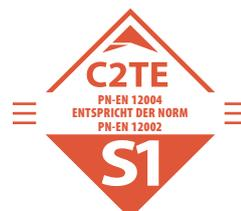
Dritter Parameter zur Beschreibung des Klebers ist die Bezeichnung der Querverformung, die anhand der Norm PN-EN 12002 durchgeführt wird. Diese Bezeichnung definiert die zulässige Größe der Verformung der Oberfläche mit ausgehärtetem Kleber, ohne deren Beschädigung. Die Kennzeichnung S1 setzt die zulässige Durchbiegung zwischen 2,5 – 5 mm, S2 – über 5 mm.
