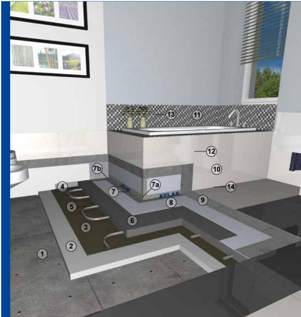
1. der Untergrund 2. die thermische und akustische Isolation 3. die PE-Folie 4. DILATATIONSPROFIL ATLAS 5. die Heizungsrohre
