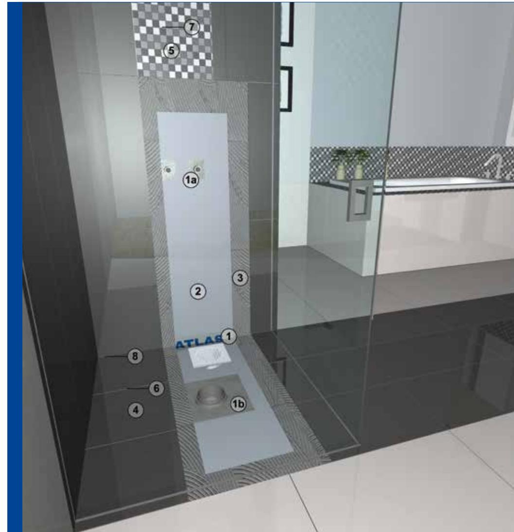
1. das ABDICHTUNGSBAND ATLAS 1a. der ABDICHTUNGSRING ATLAS – die Wand 1b. Der ABDICHTUNGSRING ATLAS – der FUßBODEN
