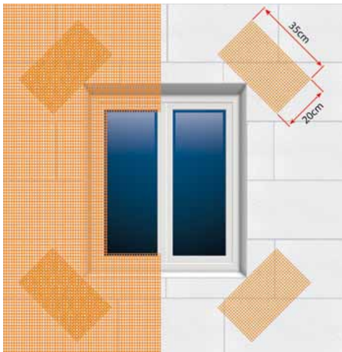
PRAWDŁOWE WZMOCNIENIE NAROŻNIKÓW OTWORÓW OKIENNYCH
