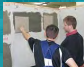
Badanie korygowalności kleju – uwagi opiekunowi ze strony Atlasa przekazuje jeden z wykonawców
