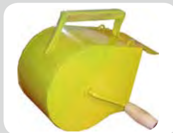
Ręczna maszyna i miotła - urządzenia, które kiedyś służyły do nakładania „baranka”.
