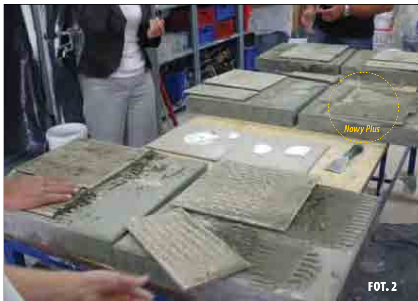
FOT. 2 Nowy Plus i konkurencja. Płytki oderwane po 24 godz. Konsystencja klejów podobna. Proszę zwrócić uwagę na przyczepność nowego Plusa do płytki.
