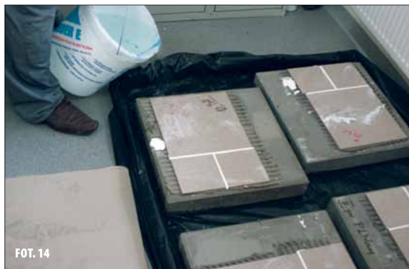
FOT. 14,15. Płyty betonowe zanurzone w wodzie. Test kapilarnego transportu wody.
