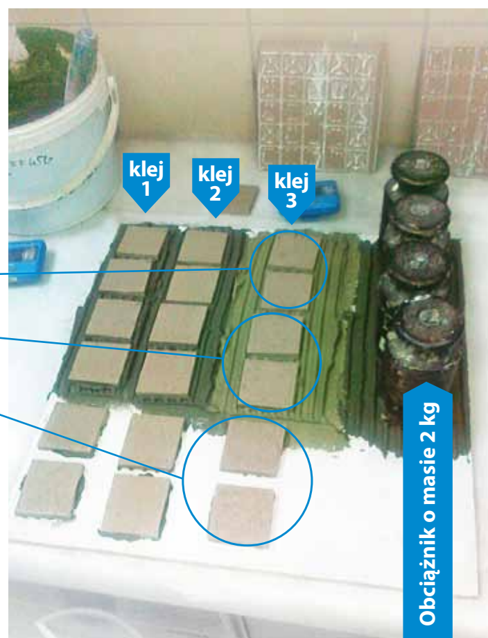
Fot. 2. Trzy sposoby przyklejania płytek w zależności od rodzaju zastosowanego kleju: podstawowa, kombinowana, klej tylko na płytkę
