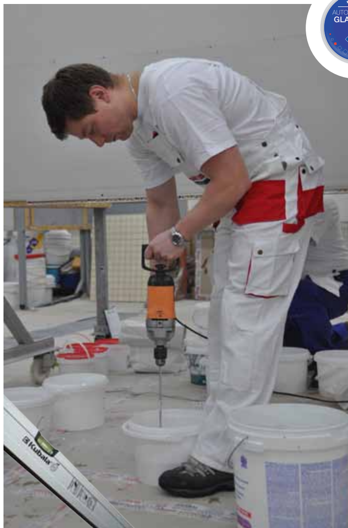
Fot. 3 Podczas testu w kategorii „urabialność” najwyższe noty uzyskał ATLAS Gipsar Plus i Megaron Super Finish.
