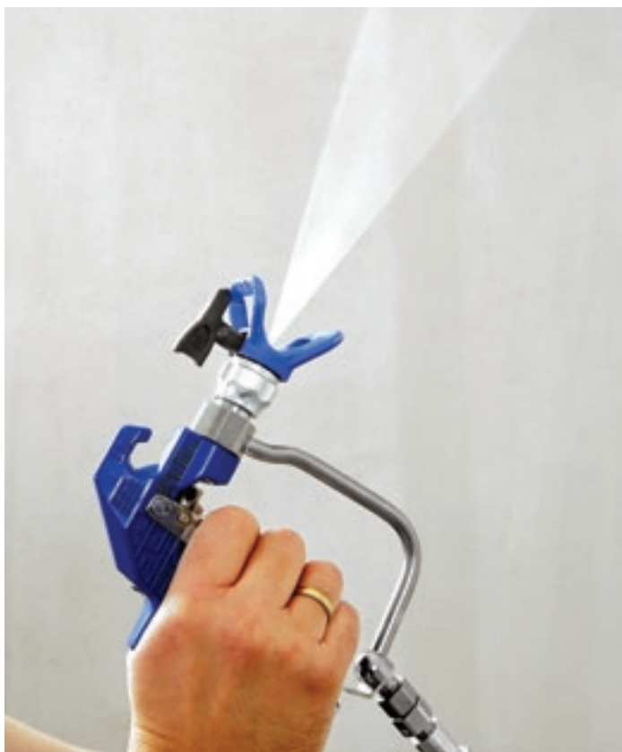
Fot. 2. Dobór dyszy powinien być uwarunkowany między innymi rodzajem szpachlowanej powierzchni.
