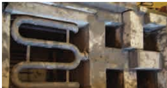
Fot. 3. Układ rurowy pozwala przekazać oraz zgromadzić w masie kumulacyjnej paleniska i komory spalania o 40% więcej ciepła w porównaniu z wkładem z płaszczem wodnym.
