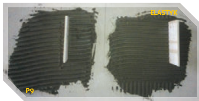
Fot. 1. Sprawdzamy przyczepność w ekstremalnych warunkach. Płytki przyklejone kantem
