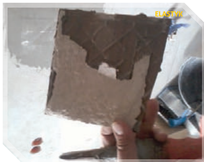
Fot. 5 i 6. Odklejenie płytki na ścianach po 4 dniach. W obu przypadkach nastąpiło rozerwanie w warstwie kleju
