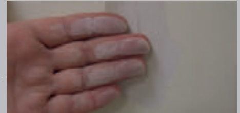
Fot. 4. Efekt niedostatecznie zagruntowanego podłoża
