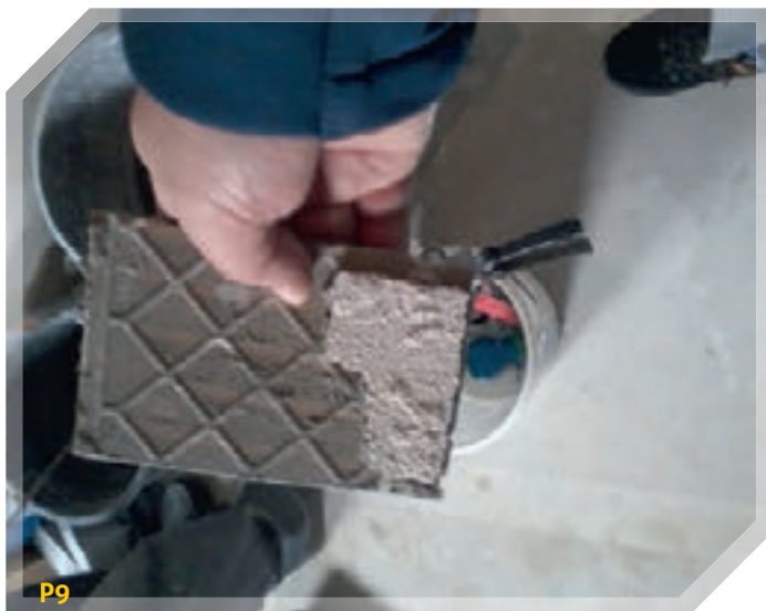
Fot. 5 i 6. Odklejenie płytki na ścianach po 4 dniach. W obu przypadkach nastąpiło rozerwanie w warstwie kleju
