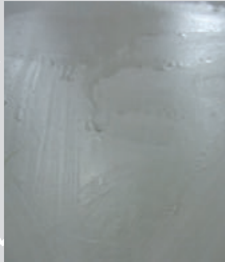
Fot. 3. Efekt zastosowania gruntu nierozcieńczonego
