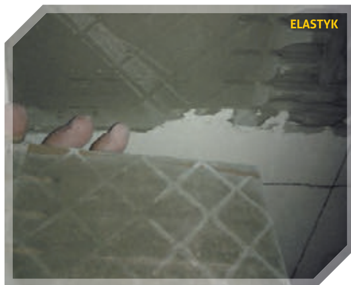
Fot. 3 i 4. Po odklejeniu od podłoża rozerwanie nastąpiło w warstwie kleju, P9 był bardzo miękki (wyraźne głębokie zarysowania), Elastyka udało się jedynie powierzchnie zadrapać szpachelką
