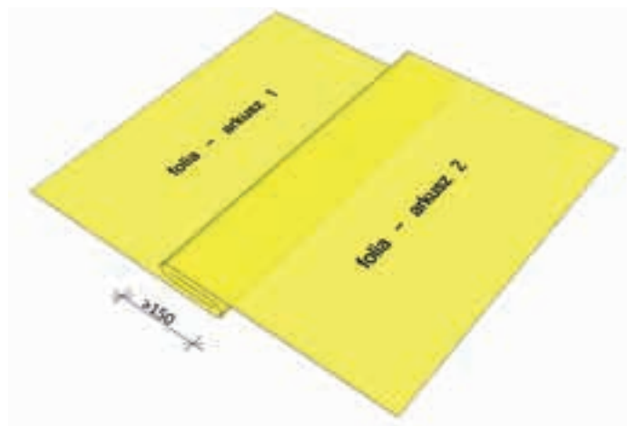
Fot. 1. Prawidłowy sposób układania folii na zakład bez sklejania. Wymiary podano w milimetrach
