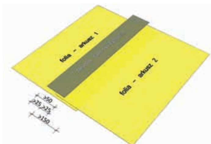
Fot. 2. Sposób jednostronnego sklejania folii. Wymiary podano w milimetrach
