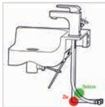
prawidłowe ułożenie wężyków w baterii sztorcowej
