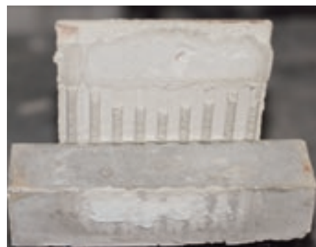
Fot. 6. Próbkę do badań elastyczności wzorowana na DIN 18156-3 po zniszczeniu
