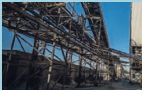
Fot. 1. W pierwszym etapie surowiec zostaje uwodniony i przesiany na stacji przygotowania pulpy
