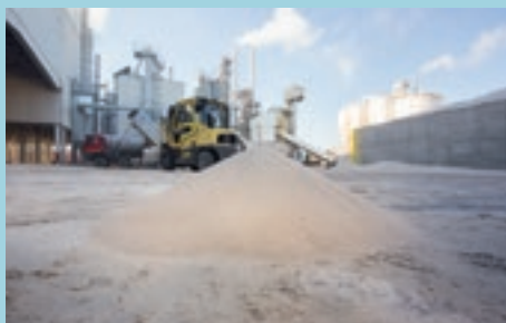
Fot. 2. Osuszony i oczyszczony piasek kwarcowy jest przygotowany do produkcji zaprawy
