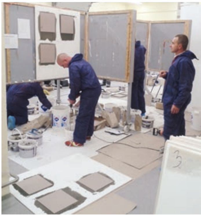
Fot. 1. Wykonawcy podczas testów na poligonie w Zgierzu testują rozrabianie kleju w wiadrze
