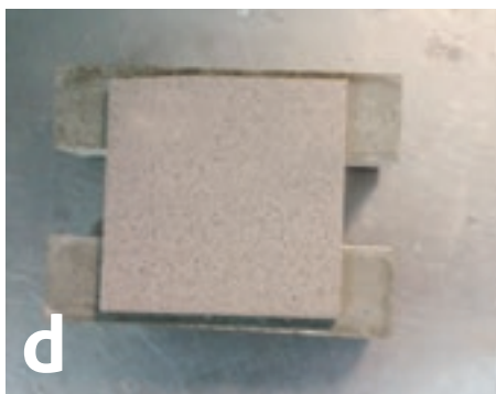
Fot. 5a–5e. Próbkę do badań elastyczności wzorowane na DIN 18156-3
