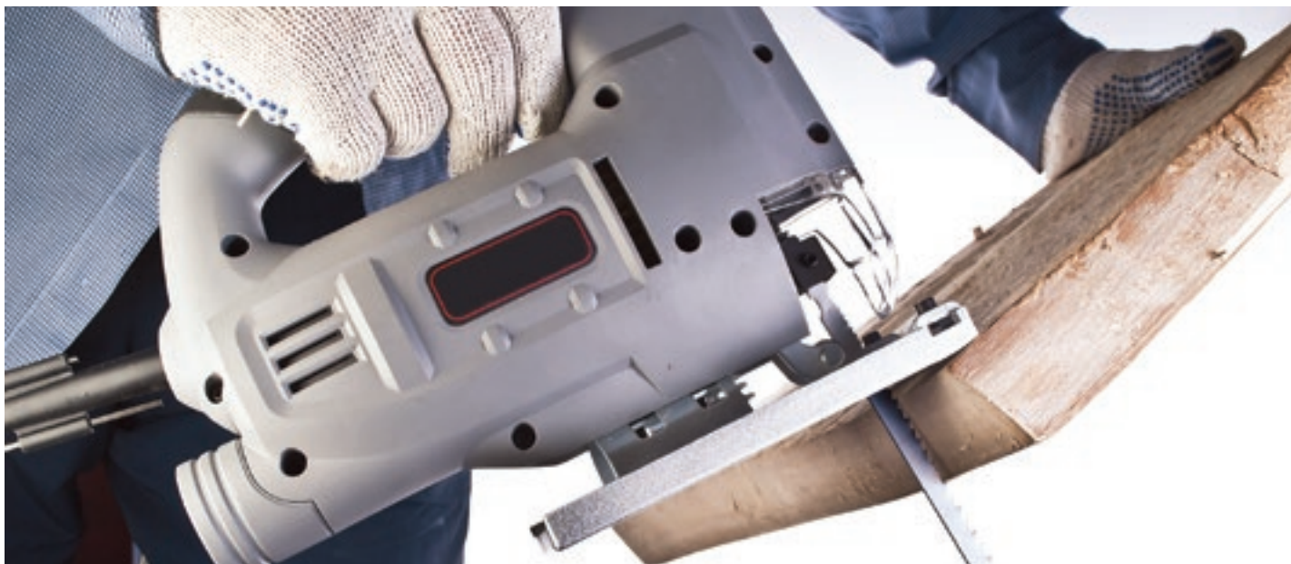
Fot. 1. Moc, prędkość skokowa i grubość cięcia to istotne parametry wyrzynarek
