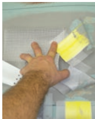
Fot. 7. Próbkę nr 3 – mocne zespolenie taśmy z podłożem
