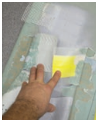
Fot. 5. Próbkę nr 1 – taśma odrywa się od podłoża, mocne zespolenie z siatką
