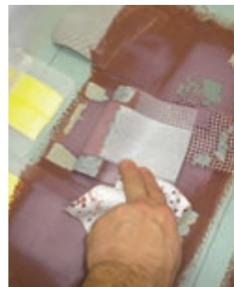
Fot. 6. Próbkę nr 2 – mocne zespolenie taśmy z podłożem, duża spoiwość materiału
