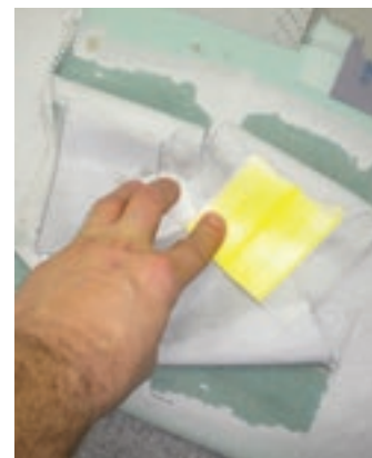
Fot. 8. Próbkę nr 4 – mocne zespolenie taśmy z podłożem
