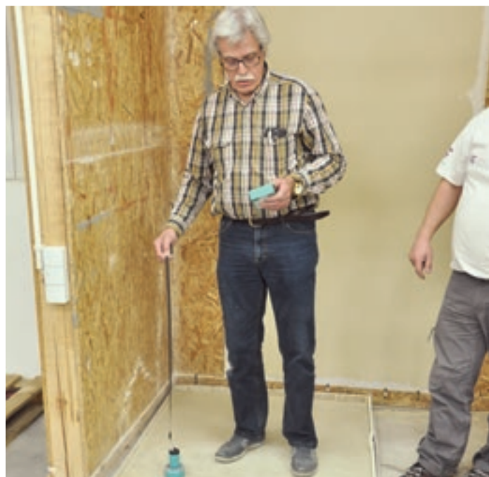
Fot. 7. Jarosław Kurnikowski, parkieciarz, podczas prezentacji jednej z metod badania wilgotności podkładu
