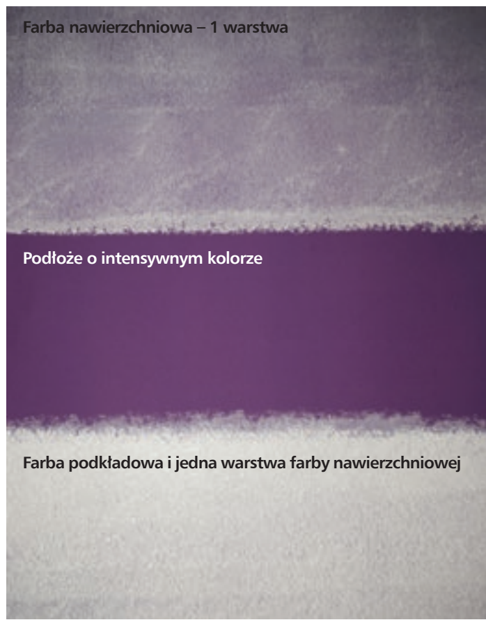
Fot. 1. Na zdjęciu farba nawierzchniowa pomalowana jednokrotnie (u góry) oraz farba podkładowa + jedna warstwa farby nawierzchniowej (na dole). Widocznie lepsze jest krycie farby nawierzchniowej po zastosowaniu farby podkładowej. Przy tak intensywnym kolorze podłoża całkowite przykrycie starej powłoki nastąpi jednak dopiero po podwójnym malowaniu
