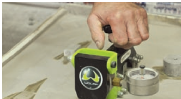
Fot. 3. Drugi etap badania wytrzymałości na ścinanie. Oderwanie klocków od podkładu
