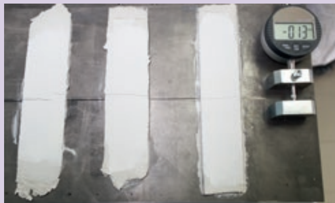
Fot. 2. Badanie stopnia spękania powierzchni. Tynk cementowo-wapienny, na którym położona jest warstwa gruntu i farby podkładowej ATLAS. Widoczny wskaźnik elektroniczny pokazuje szerokość szczeliny, jaka powstaje w wyniku rozsunięcia stołu badawczego
