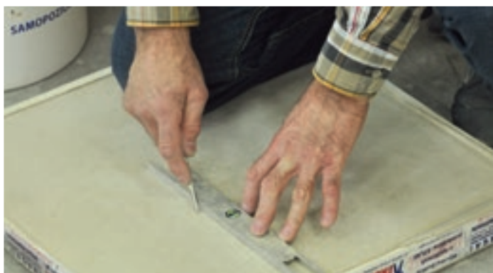
Fot. 6. Ocena twardości podkładu anhydrytowego ATLAS SAM 100 po siedmiu dniach od wylania
