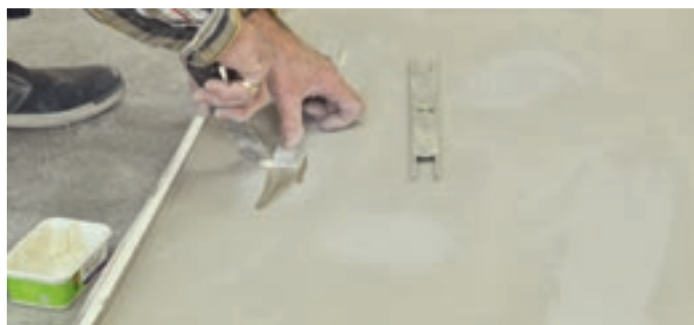
Fot. 2. Pierwszy etap badania wytrzymałości podkładu na ścinanie. Przyklejenie klocków do podkładu
