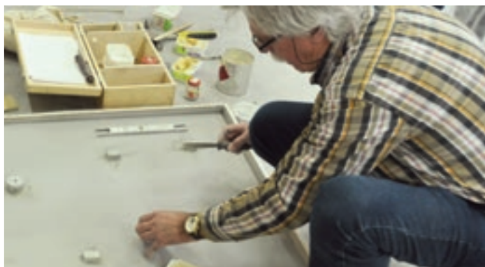
Fot. 4. Trzeci etap badania wytrzymałości masy szpachlowej na ścinanie. Sprawdzenie wartości po oderwaniu klocków
