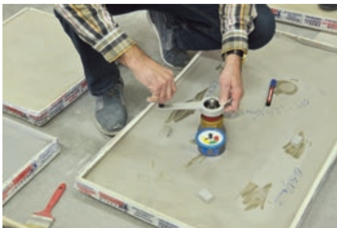
Fot. 5. Badanie wytrzymałości podkładu na zrywanie jest wykonywane metodą pull off
