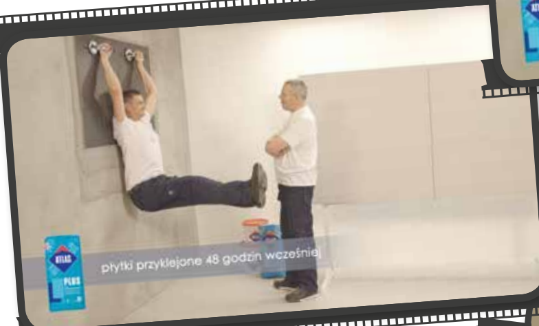
Fot. 5. Ekstremalna przyczepność. Plus jest klejem zawierającym z jednej strony dużą ilość polimerów, co wpływa na parametry robocze i ułatwia pracę, a z drugiej – jest bogaty w substancje aktywujące, dzięki którym po 48 godz. osiąga bardzo wysoką przyczepność. Co widać na zdjęciu
