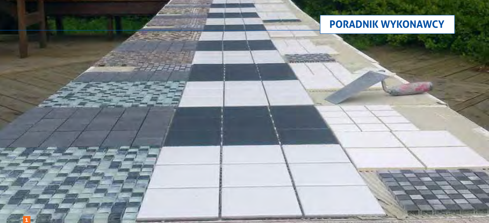
1 Stół przygotowany na przeprowadzenie testów fug – różne formaty i rodzaje okładzin.
