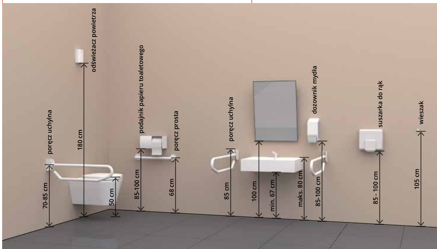
Rys. 1. Maksymalne odległości od podłoża w wyposażeniu łazienki dla niepełnosprawnych
