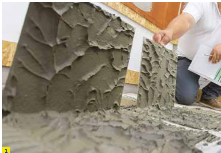
1 Geoflex doskonale wypełnia przestrzeń pod płytką (gres 30 x 30 cm). Wykazuje także większą rozptywność niż tradycyjne kleje cementowe.
