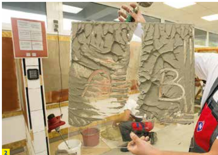
2 Geoflex (po prawej) oznaczony jako B. Konkurencyjny klej żelowy (po lewej) oznaczony jako A. Przy zastosowaniu takiej samej siły klej oznaczony jako B lepiej się rozptywa pod płytką, co za tym idzie – lepiej wypełnia przestrzeń pod płytką.
