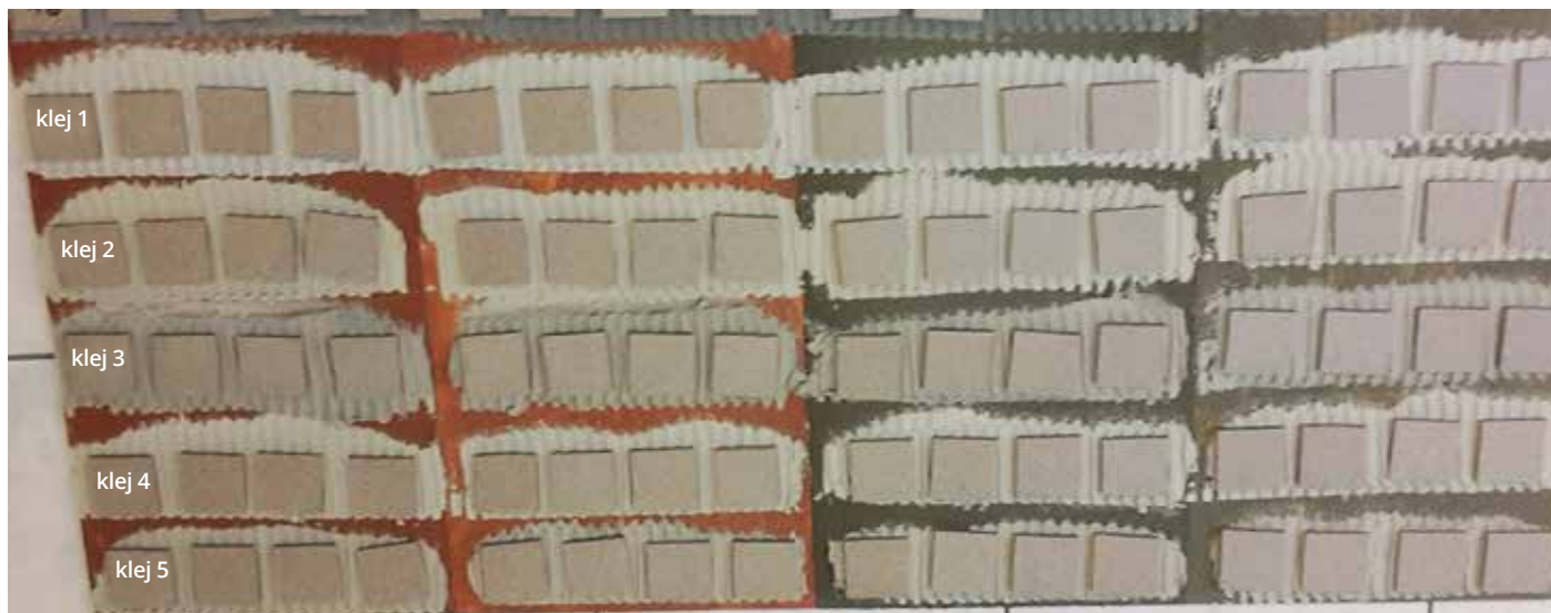
Próbki przed zerwaniem. Podłoże – od lewej: Woder W (2 warstwy), Woder W (1 warstwa), Woder Duo (2 warstwy), Woder Duo (1 warstwa).
