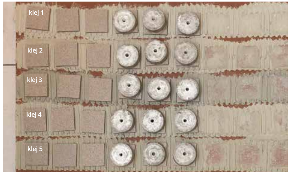
Próbki przyklejone do OSB. Podłoże – Woder W. Krążki przygotowane do zerwania.
