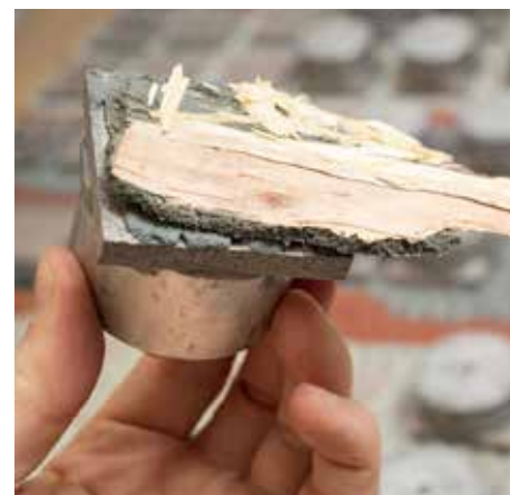
Próbka po zerwaniu – rozwarstwienie w płycie OSB. Połączenie klejowe okazało się mocniejsze niż siły spójności w płycie.
