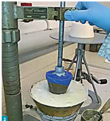
Fot. 1-3. Pomiar konsystencji i plastyczności ATLAS Artis za pomocą penetrometru (fot. 1), stożka opadowego (fot. 2) i na stoliku wstrząsowym (fot. 3).
