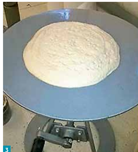
Fot. 1-3. Pomiar konsystencji i plastyczności ATLAS Artis za pomocą penetrometru (fot. 1), stożka opadowego (fot. 2) i na stoliku wstrząsowym (fot. 3).
