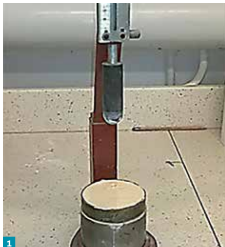
Fot. 1-3. Pomiar konsystencji i plastyczności ATLAS Artis za pomocą penetrometru (fot. 1), stożka opadowego (fot. 2) i na stoliku wstrząsowym (fot. 3).
