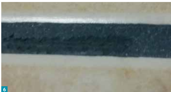
Fot. 5, 6. Odporność na zarysowanie spoiny grafitowej: zdjęcie po lewej – efekt użycia rysika stalowego na powierzchni zaprawy do spoinowania o prawidłowej proporcji wody, po prawej – analogiczna próba w przypadku spoiny, do której przygotowania użyto o 30% więcej wody zarobowej.
