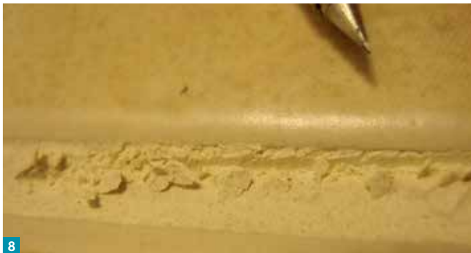
Fot. 7, 8. Odporność na zarysowanie spoiny jaśminowej: zdjęcie po lewej – efekt użycia rysika stalowego na powierzchni zaprawy do spoinowania o prawidłowej proporcji wody, po prawej – analogiczna próba w przypadku spoiny, do której przygotowania użyto o 30% więcej wody zarobowej.
