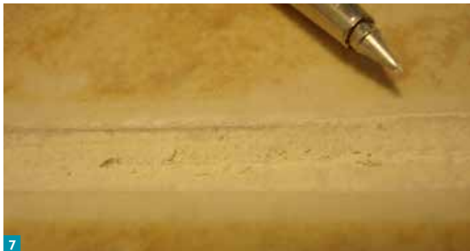
Fot. 7, 8. Odporność na zarysowanie spoiny jaśminowej: zdjęcie po lewej – efekt użycia rysika stalowego na powierzchni zaprawy do spoinowania o prawidłowej proporcji wody, po prawej – analogiczna próba w przypadku spoiny, do której przygotowania użyto o 30% więcej wody zarobowej.
