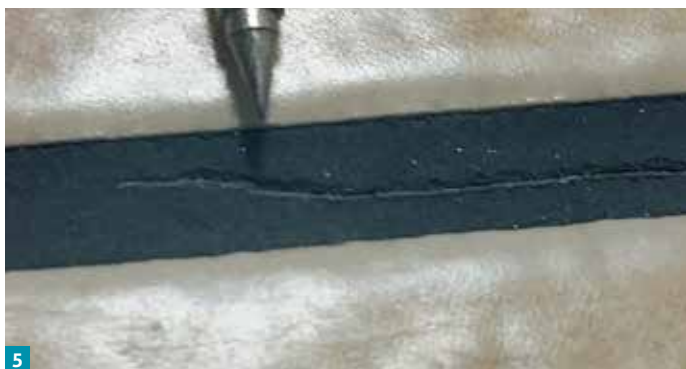
Fot. 5, 6. Odporność na zarysowanie spoiny grafitowej: zdjęcie po lewej – efekt użycia rysika stalowego na powierzchni zaprawy do spoinowania o prawidłowej proporcji wody, po prawej – analogiczna próba w przypadku spoiny, do której przygotowania użyto o 30% więcej wody zarobowej.
