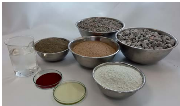
Fot. 1. Składniki betonu – ich pochodzenie skutkuje zmiennością ich składu oraz wpływa na wybarwienie betonu
