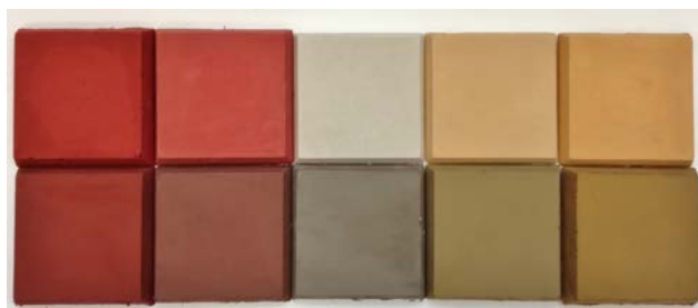
Fot. 4. Wpływ koloru cementu oraz wysokości dozowania pigmentu na wybarwienie. Rząd górny od lewej: biały cement, dozowanie pigmentu czerwonego – 6%, 3%, bez pigmentu, dozowanie pigmentu żółtego – 3%, 6%. Rząd dolny od lewej: szary cement, dozowanie pigmentu czerwonego – 6%, 3%, bez pigmentu, dozowanie pigmentu żółtego – 3%, 6%
