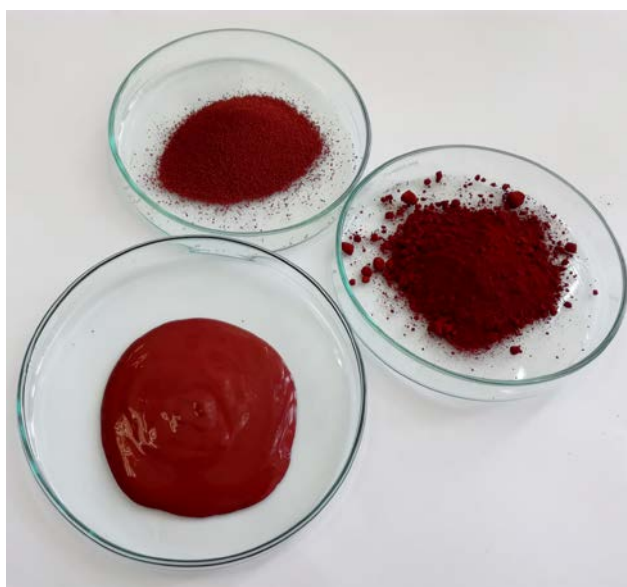
Fot. 3. Podstawowe formy handlowe pigmentów – proszek, granulat, wodna dyspersja
