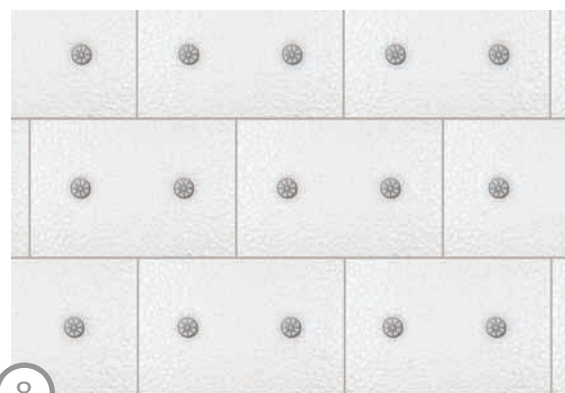
8 ПЕНОПОЛИСТИРОЛ – ДЮБЕЛИ РАЗМЕЩАЮТСЯ ПОСЕРЕДИНЕ НА ПОВЕРХНОСТИ ПЛИТЫ
