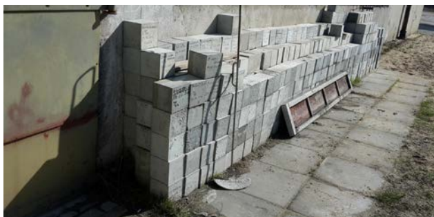
Fot. 1. Przykład nieprawidłowego przechowywania próbek betonowych w jednej z wytwórni betonu towarowego
