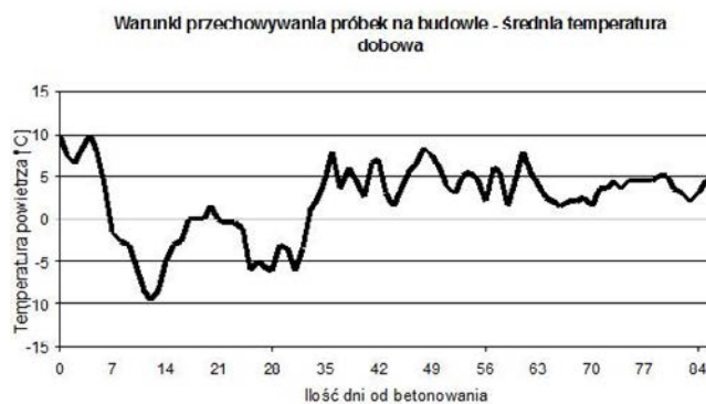
Rys. 7. Warunki przechowywania próbek na budowie - zestawienie średnich temperatur dobowych w okresie od 1. do 90. dnia od betonowania
