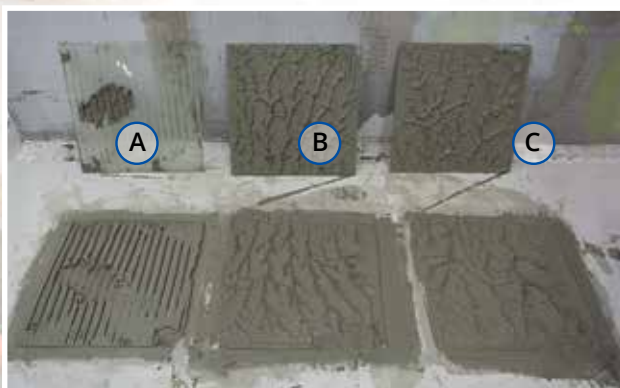
Ocena spływu kleju przy różnych wielkościach płytek.
