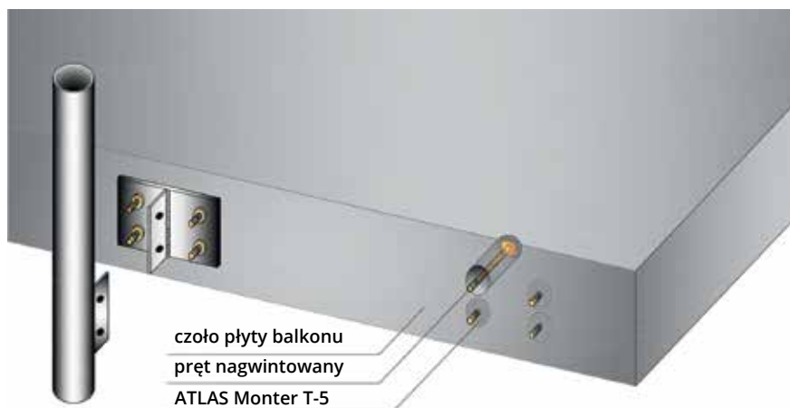
Rys. 3. Przykładowy schemat montażu balustrady balkonowej (I. Gawęda)
