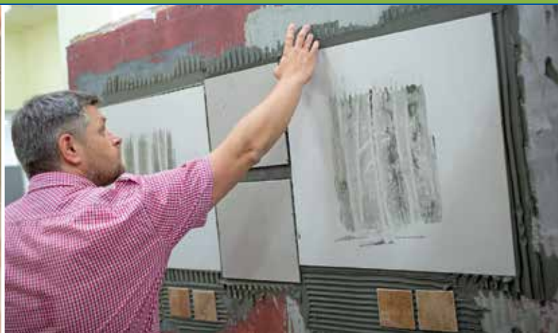
Ocena spływu kleju przy różnych wielkościach płytek.
