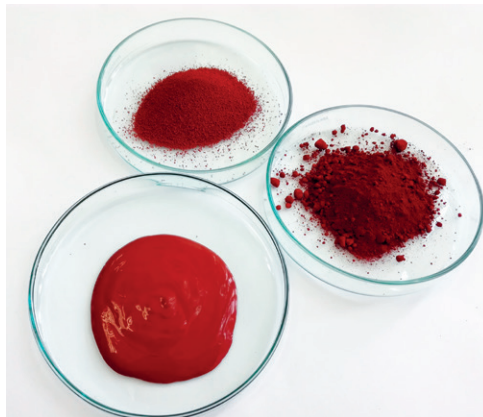
Fot. 3. Podstawowe formy handlowe pigmentów – proszek, granulata, wodna dyspersja
