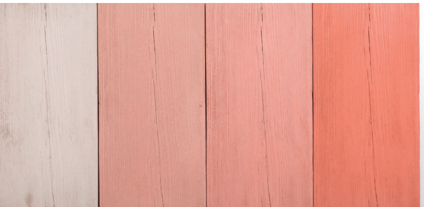
Fot. 7b (zdjęcie powyżej). Wpływ dozowania pigmentu czerwonego SR-010 na wybarwienie betonu. Od lewej: 1% m.c., 4% m.c., 8% m.c., 12% m.c.
