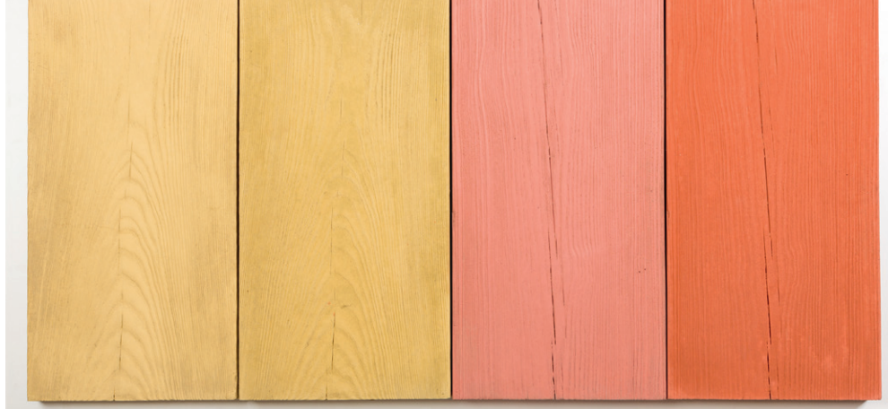
Fot. 8. Wpływ koloru kruszywa na wybarwienie betonu Od lewej: pigment żółty SY-020 - kruszywo jasne, kruszywo ciemne, pigment czerwony SR-010- kruszywo jasne, kruszywo ciemne
