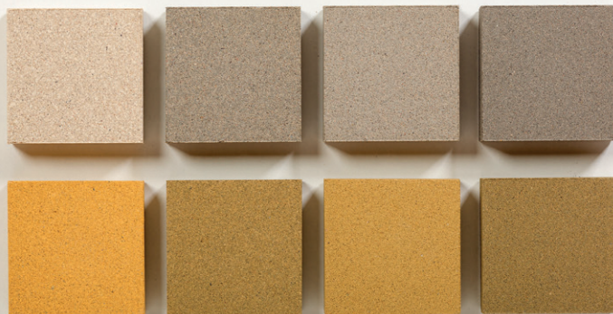
Fot. 6. Wpływ koloru cementu na wybarwienie betonu. Rząd górny: próbki wzorcowe bez pigmentu. Rząd dolny od lewej: pigment żółty SY-020 6,0% m.c. CEM I 52,5R biały, CEM I 42,5R, CEM III/A 42,5N, CEM II A-V 42,5R
