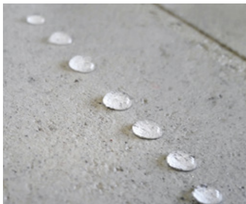
Lakier Hydrofobowy vs. Lakier Dekoracyjny. Na Lakierze Hydrofobowym widoczny efekt perlenia. Woda na Lakierze Dekoracyjnym rozplywa się, a po dłuższym czasie wsiąka w Beton.
