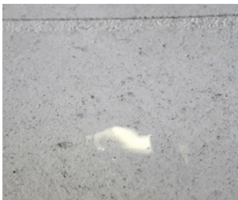
Beton marki Fox Dekorator zaimpregnowany Lakierem Hydrofobowym. Nawet po tak długim czasie woda nie wnika w podłoże.
