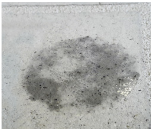
Beton marki Fox Dekorator zaimpregnowany Lakierem Dekoracyjnym. Woda stopniowo wsiąka w podłoże, pozostawiając ślad.
