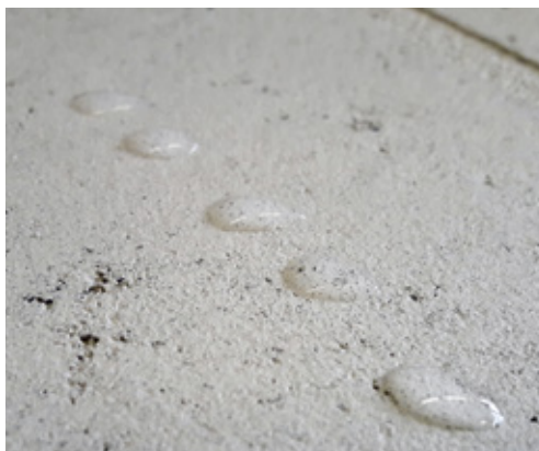
Lakier Hydrofobowy vs. Lakier Dekoracyjny. Na Lakierze Hydrofobowym widoczny efekt perlenia. Woda na Lakierze Dekoracyjnym rozplywa się, a po dłuższym czasie wsiąka w Beton.
