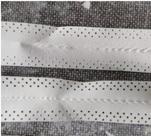
Taśma zerwana po nałożeniu – jak widać po marszczeniach, Stoner trzymał trochę mocniej, ale GTA też łatwo nie uległa zerwaniu.
