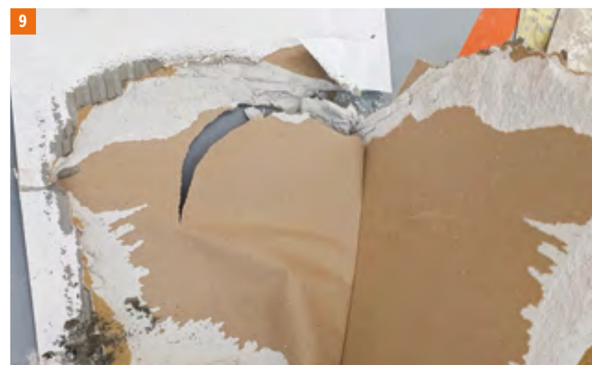
Fot. 8, 9 Geoflex Express. Test zrywania płytki po 1,5 godz., lecz przy użyciu maksymalnej ilości wody zarobowej (7,5 l/25 kg): próba odrywania – znisz- czenie podłoża.
