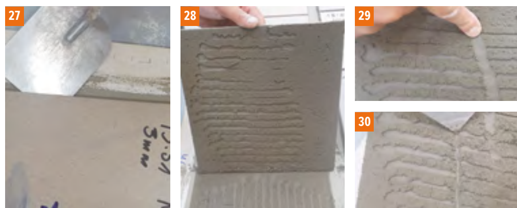
Fot. 27, 28, 29, 30 Klej szybkowiązący nr 1 (klasa „F”): test po 2 godz. wiązania w warstwie o grubości 3 mm. Test twardości wykonany szpachelką – podobny do wyżej opisanego (fot. 13, 14, 15). Zerwanie płytki nastąpiło w warstwie kleju. Klej daje się łatwo wycierać z powierzchni płytki palcem, ostrą krawędzią kielenki – rysujemy do podłoża.
