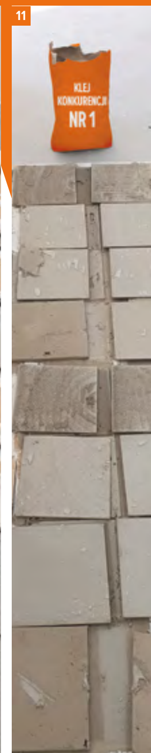
Fot. 10, 11, 12 Wyniki testów zrywań wybranych klejów według schematu z rys. 1. Poza sposobem zerwania trzeba zwrócić również uwagę na skalę przebarwienia kleju pod płytką, co świadczy o tempie utraty wilgotności zapraw klejących, przyroście wytrzymałości oraz możliwości rozpoczęcia fugowania okładzin ceramicznych.
