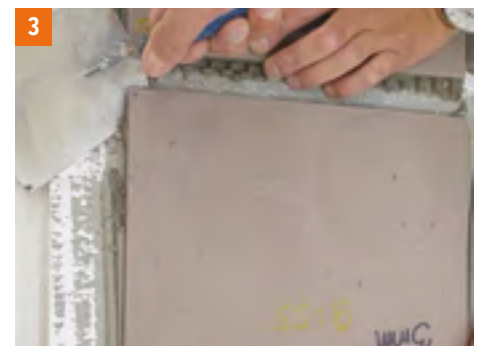
Fot. 1, 2, 3 Zaprawa klejowa ATLAS Geoflex Express – klejenie w warunkach letnich, temperatura otoczenia 28,5°C, grubość warstwy 3 mm, testy po 1,5 godz. Od lewej: 1. Test obciążenia (z obrotem) – brak zapadania płytki lub jej odspojenia, 2. Test odrywania (oderwanie przy użyciu tzw. poręczy), 3. Test twardości – kielenka wchodzi na kilka mm pod płytkę.
