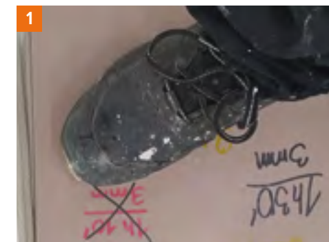
Fot. 1, 2, 3 Zaprawa klejowa ATLAS Geoflex Express – klejenie w warunkach letnich, temperatura otoczenia 28,5°C, grubość warstwy 3 mm, testy po 1,5 godz. Od lewej: 1. Test obciążenia (z obrotem) – brak zapadania płytki lub jej odspojenia, 2. Test odrywania (oderwanie przy użyciu tzw. poręczy), 3. Test twardości – kielenka wchodzi na kilka mm pod płytkę.
