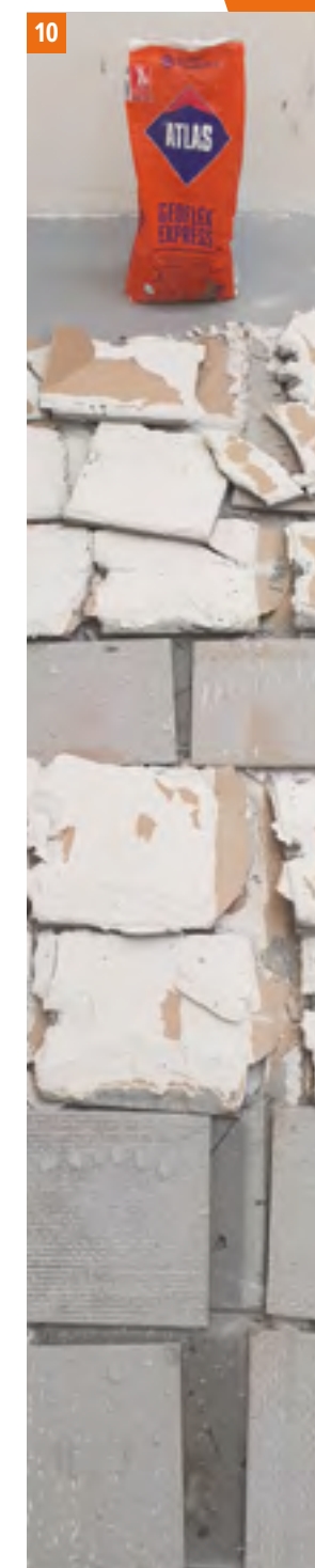
Fot. 10, 11, 12 Wyniki testów zrywań wybranych klejów według schematu z rys. 1. Poza sposobem zerwania trzeba zwrócić również uwagę na skalę przebarwienia kleju pod płytką, co świadczy o tempie utraty wilgotności zapraw klejących, przyroście wytrzymałości oraz możliwości rozpoczęcia fugowania okładzin ceramicznych.
