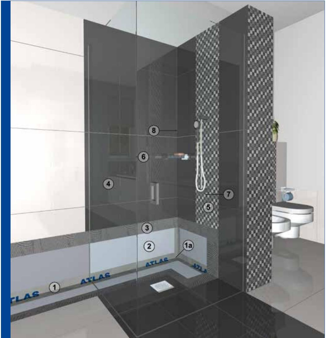
1. das ABDICHTUNGSBAND ATLAS oder ATLAS HYDROBAND 1a. die DICHTUNGSINNENECKE ATLAS oder ATLAS HYDROBAND 2. die Hydroisolierung ATLAS WODER E oder ATLAS WODER DUO 3. Verformbarer Kleber ATLAS PLUS 4. die Fliesen 5. das Mosaik 6. die Fuge ATLAS ARTIS 7. die Fuge ATLAS Elastischer Fugenmörtel 8. das Silikon ATLAS ARTIS
