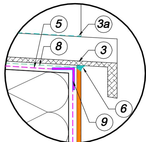
Nr. 1.3.2 Die Wärmeisolierung der Fensterbrüstung mit dem zurückgezogenen Fenster mit dem Eckprofil
