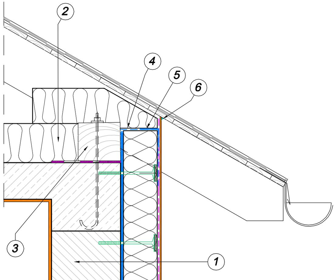
1. DIE ISOLIERTE WAND IN EINEM WÄRMEDÄMMUNGSSYSTEM ATLAS
