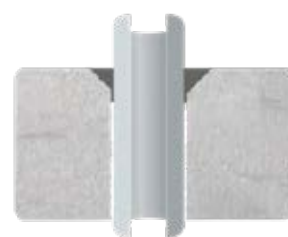
usadenie potrubných prestupov
