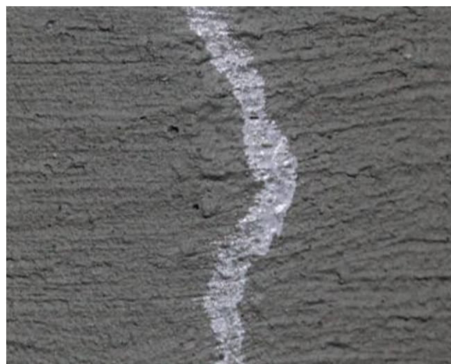
Фот. 5. Медленное наращивание кристаллов соли на поверхности трещины, уплотнение. Эффект через 35 дней.
