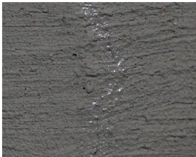
3 nuotr. Druskų kristalai pamažu užpildo įtrūkį, dar yra nedidelis vandens protėkis. Rezultatas po 7 dienų.
