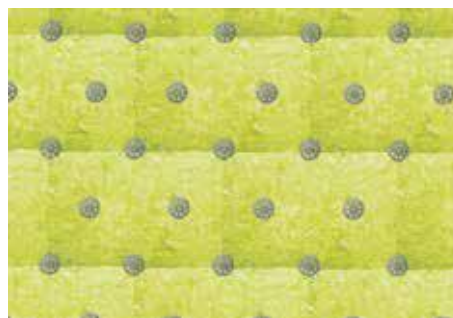
MINERÁLNÍ VLNA - ROZPĚRNÉ KOTVY JSOU UMÍSTĚNY VE STŘEDU A V ROZÍCH SOUSEDNÍCH DESEK
